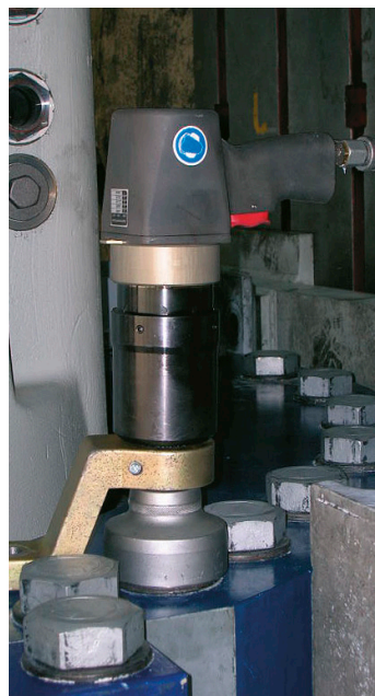
alkitronic® PC-S Schraubmaschinen im Einsatz (Abbildungen rechts). Verschraubungen an einem Schraubenkranz sowie an einem Dieselaggregat für Großbaumaschinen.
